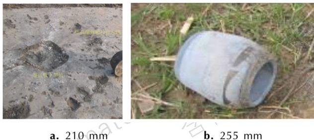
图 6 高速射流穿过不同厚度盖板引爆 PBX 后样品壳体
