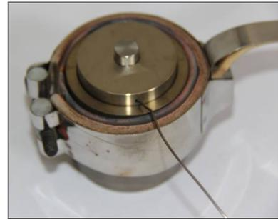
图 2 高温炸药撞击感度试验装置照片
