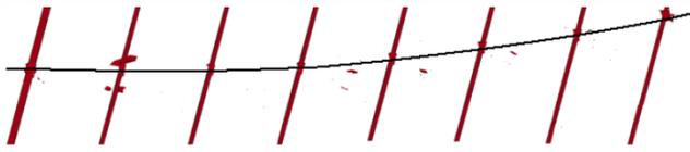
图14  $-627^{\circ}\cdot\text{s}^{-1}$ 俯仰角速度影响下弹丸轨迹数值模拟结果
