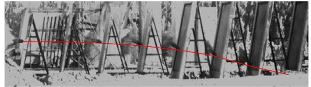
图3 弹丸侵彻8层钢筋混凝土薄靶试验的试验弹道图
