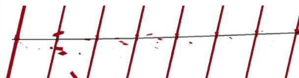
图 12  $-427^{\circ}\cdot\text{s}^{-1}$ 俯仰角速度影响下弹丸弹道数值模拟结果
