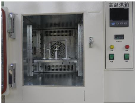
图3 慢烤实验装置实物照片
