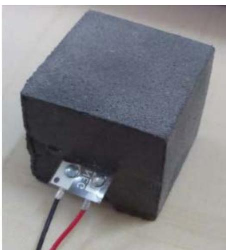
图 13 嵌入 PVDF 传感器的推进剂试件<sup>[61]</sup>
