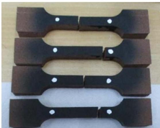
图1 完成单轴试验后哑铃型试件的照片<sup>[19]</sup>
