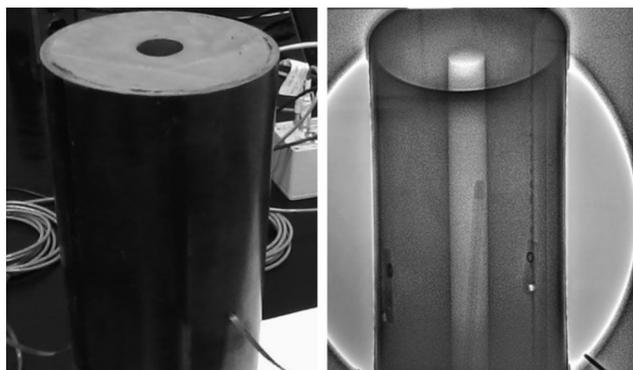
图11 模拟发动机的照片和X射线图片<sup>[54]</sup>
