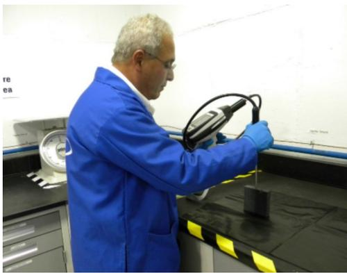
图6 microPHAZIRTM 近红外手持平台<sup>[32]</sup>
