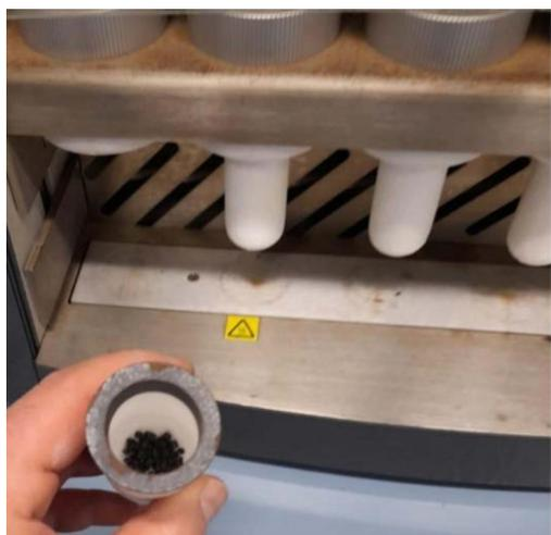
图2 提取前可溶性组分试样的照片<sup>[20]</sup>
