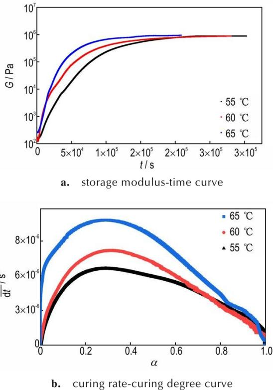
图1 BGAP基推进剂储能模量-时间曲线和不同温度下的固化速率-固化度曲线<sup>[45]</sup>
