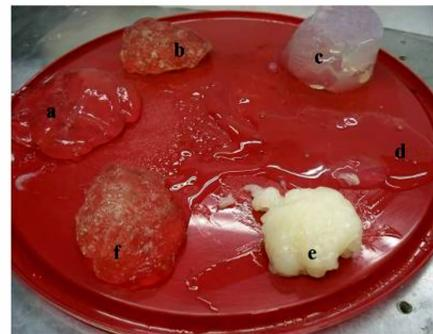
图4 Mallory制备的水基凝胶推进剂模拟液<sup>[24]</sup>
