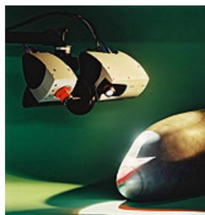
图 6 双目结构光视觉测量系统<sup>[37]</sup>
