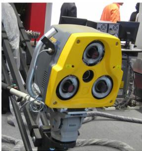
图8 白光扫描坐标测量系统<sup>[46]</sup>
