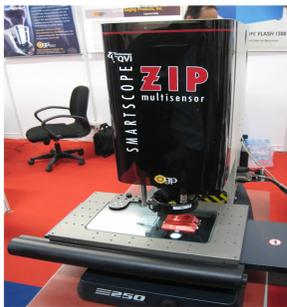
图7 复合式光学三坐标测量系统<sup>[47]</sup>
