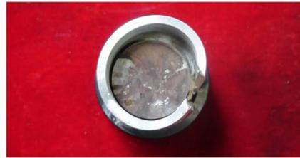
图 4 热-撞击复合试验后的击砧照片
