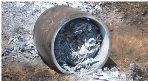
图 10 PBX-9404 炸药冲击引燃效果
