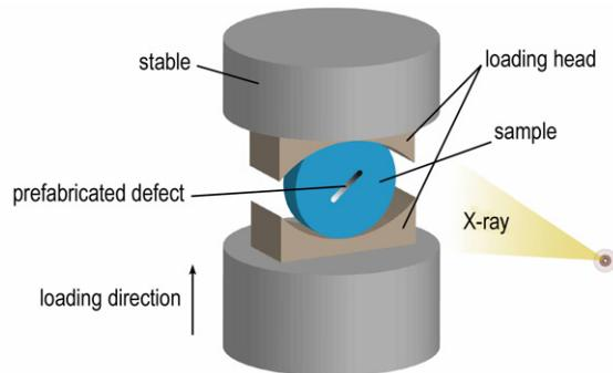
图 2 试验加载方式示意图
