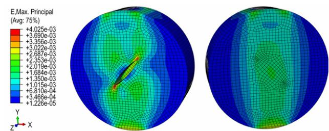
**图 13 斜 45° 非贯通缺陷样品的有限元模拟下的最大主应变分布**
