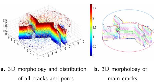
**图 11 斜 45° 贯通预制缺陷样品的三维裂纹形貌和孔隙分布**
