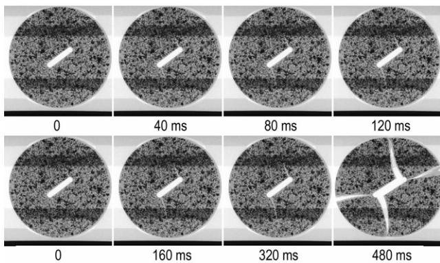
图 7 含斜 45° 贯通预置缺陷样品的起裂过程
