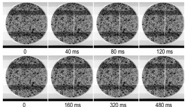
图 5 无预制缺陷样品的起裂过程
