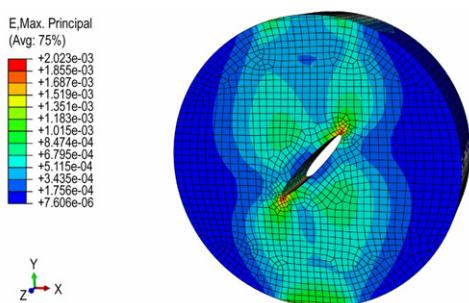
**图 14 斜 45° 贯通缺陷样品的有限元模下的最大主应变分布**
