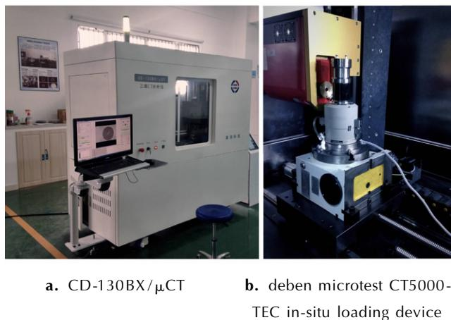
图 3 试验中所使用的 X-ray  $\mu$ CT 系统和加载装置
