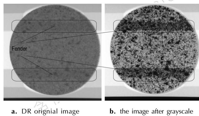
图 4 DR 图像的灰度直方图均衡化处理
