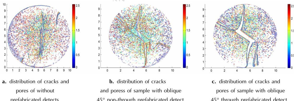
**图 12 三组样品的裂纹孔隙分布**
