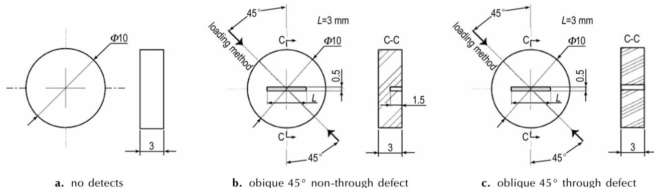
图 1 三组试验中的样品设计(单位:mm)
