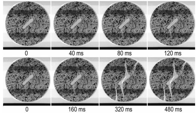
图 6 含斜 45° 非贯通预制缺陷样品的起裂过程
