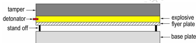
图2 设有覆盖板的爆炸焊接装置示意图
