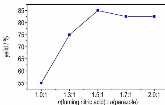
图 1 发烟硝酸与吡唑摩尔比对产物收率的影响
