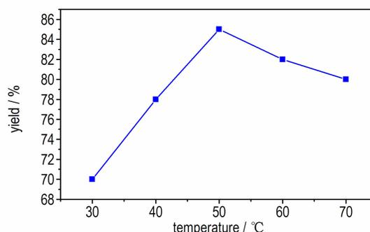
图 2 反应温度对产物收率的影响
