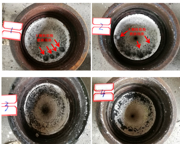
图9 对照组(1#和2#)与实验组(3#和4#)试车后发动机壳体内部照片
