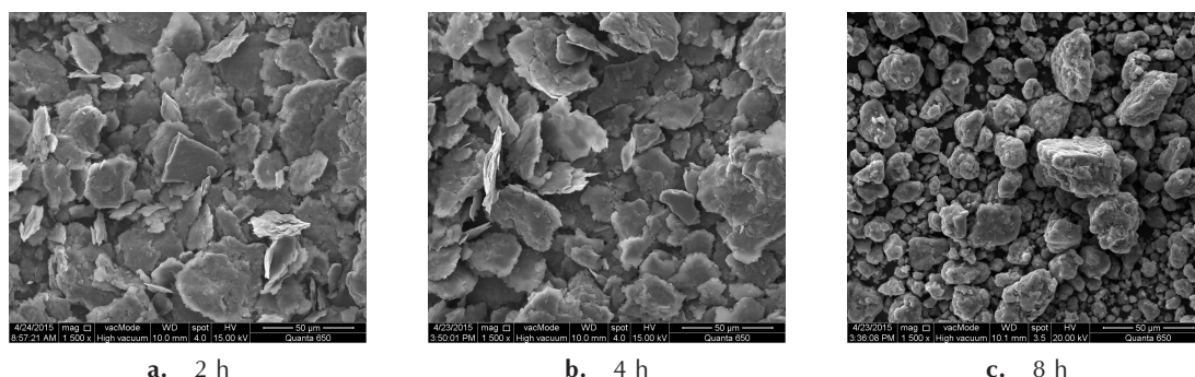
图 1 不同球磨时间 Al-FeF 3 复合燃料 SEM 形貌
