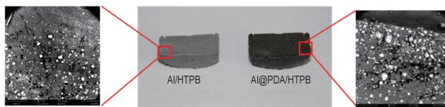
图 11 Al 和 Al@PDA 分别在 HTPB 中固化后内部颗粒分布的 SEM 照片
