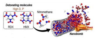
图7 纳米炸弹的制备示意图[74]
