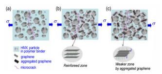
**图 4** 含不同质量石墨烯的 HMX-PBX 微裂纹微观结构图解: (a) PBX-0;(b) PBX-0.2;(c) PBX-0.8<sup>[47]</sup>
