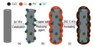
**图 1** (a)使用 PdCl₂活化 CNFs;(b)在活化 CNFs 的表面上沉积 Cu;(c)在 250 ℃的温度下进行热处理<sup>[20]</sup>
