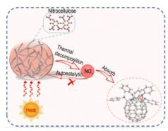
图2 多功能富勒烯衍生物的稳定机理[25]
