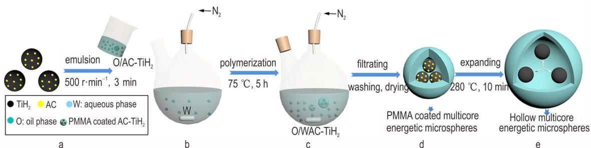
图1 悬浮聚合-固体热膨胀法制备中空含能微球的工艺流程示意图
