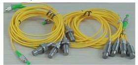
图4 硅压力传感器
