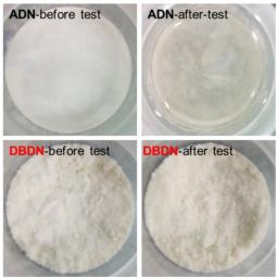
**图 7** ADN 和 DBDN 在 25 ℃、RH 66% 条件下吸湿 9 d 前后状态对比
