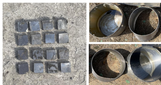
图11 试验后收集的预制飞片和圆柱壳体
