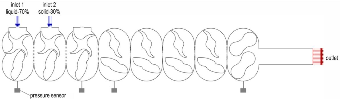
图1 多腔室结构几何模型
