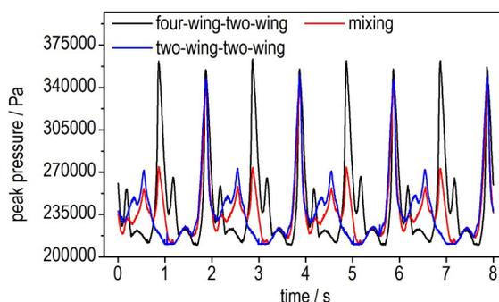
图9 出料稳定后一段时间内不同桨叶组合下捏合机内峰值压力的变化
