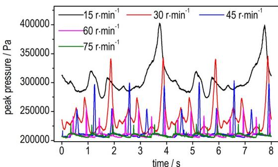
图5 出料稳定后一段时间内不同桨叶转速下捏合机内峰值压力的变化
