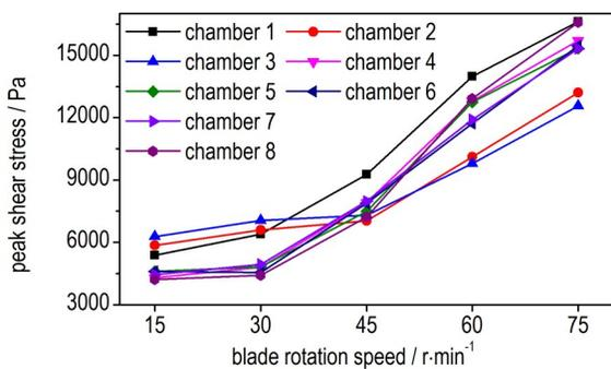
图15 各腔室内峰值剪切力随桨叶转速变化曲线
