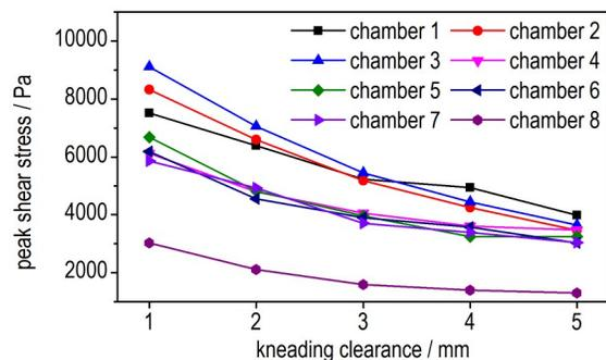
图17 各腔室内峰值剪切力随捏合间隙变化曲线
