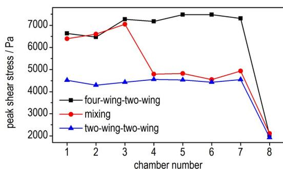
图19 不同桨叶组合下混合过程中各腔室内的峰值剪切力
