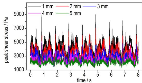
图16 出料稳定后一段时间内不同捏合间隙条件下捏合机内峰值剪切力的变化
