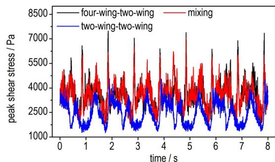
图18 出料稳定后一段时间内不同桨叶组合下腔室1~7中峰值剪切力的变化
