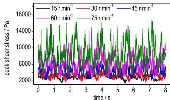
图 14 出料稳定后一段时间内不同桨叶转速下捏合机内峰值剪切力的变化
