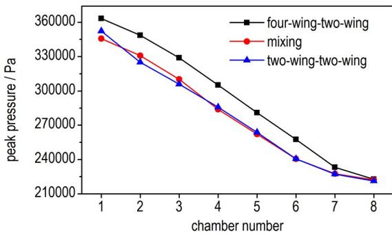
图 10 不同桨叶组合下混合过程中各腔室内的峰值压力
