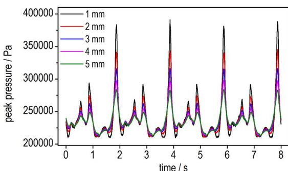
图7 出料稳定后一段时间内不同捏合间隙条件下捏合机内峰值压力的变化
