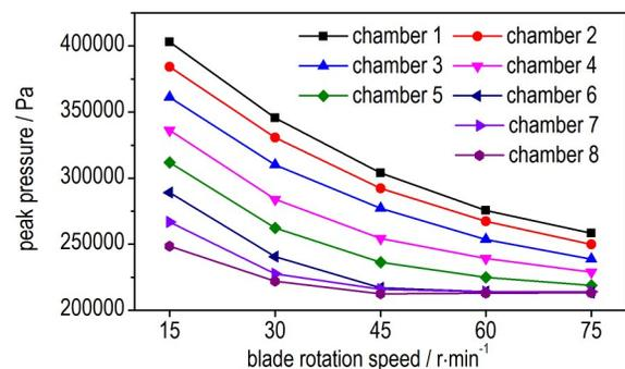
图6 各腔室内峰值压力随桨叶转速变化曲线
