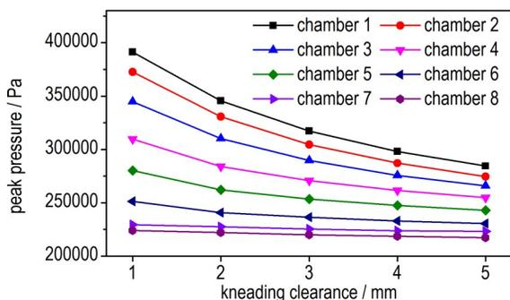
图8 各腔室内峰值压力随捏合间隙变化曲线
