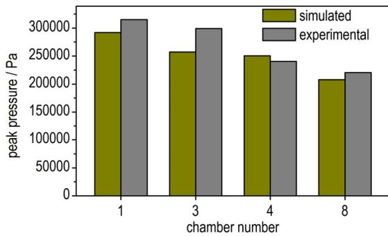
图3 试验及仿真得到的腔室底部最大压力值
