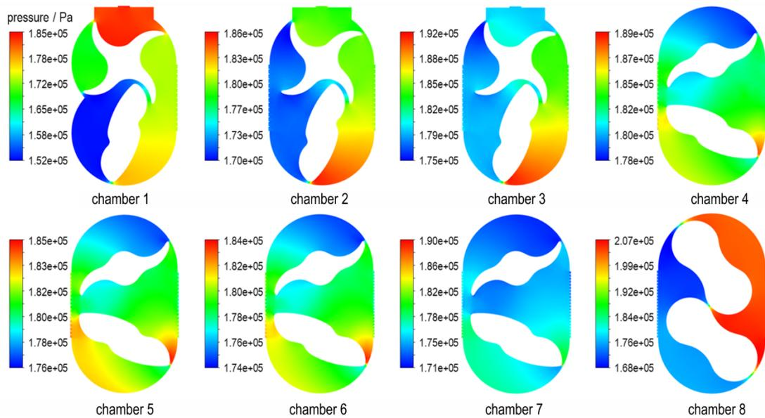
图4 出料稳定后各腔室内的压力分布
